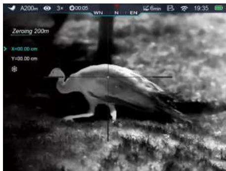
Рис. 4. Интерфейс режима пристрелки.
