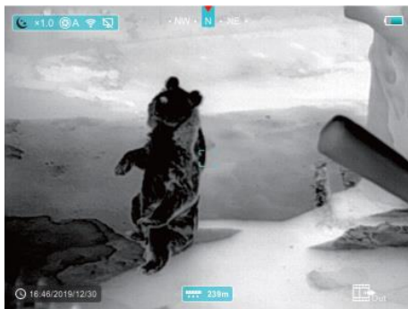
Рис. 9. Информация на экране при активном дальномере.
