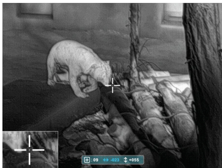
Рис. 12 Интерфейс коррекции «битых» пикселей.
