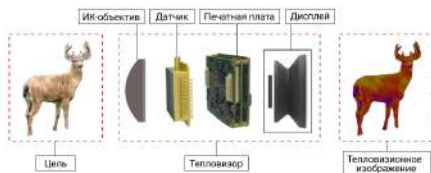
Рис. 1. Схема формирования изображения тепловизором.
