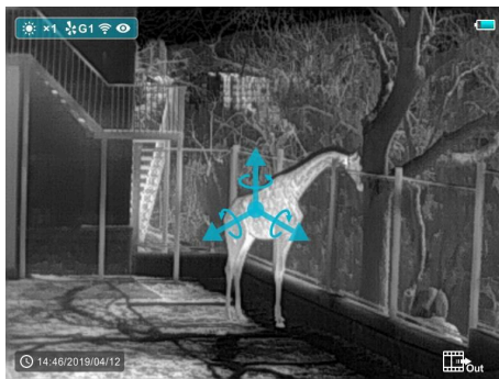
Рис. 11. Интерфейс режима калибровки компаса.
