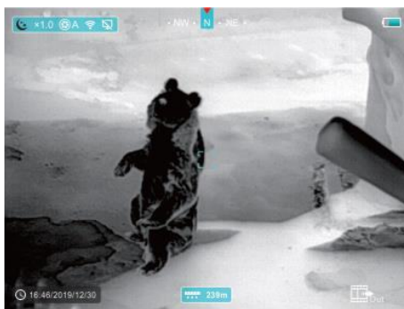
Рис. 9. Информация на экране при активном дальномере.
