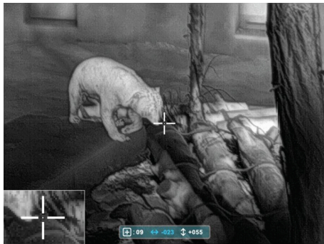
Рис. 12 Интерфейс коррекции «битых» пикселей.
